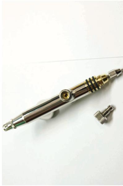
Dort sieht man, dass es an dem Messingteil einen Schlitz für einen Schraubendreher gibt. Hier kann man ein wenig die Federspannung einstellen, sprich: Wie fest man den Hebel für die Luftzufuhr drücken muss. Ich hab das zum Beispiel sehr leicht eingestellt, wobei man nicht zuviel drehen darf, weil sonst die Luft schon durchgeht, ohne dass man überhaupt den Hebel drückt.
