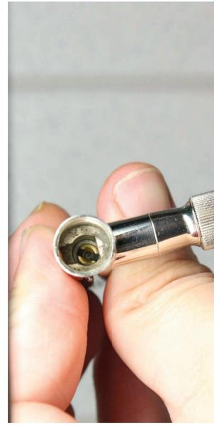
Diese weiße Teflondichtung ist einer der Kandidaten, wenn mal Luftblasen im Farbnapf blubbern, und zudem kann hier bei defekter Abdichtung Farbe in den Luftkanal gelangen, was sehr, sehr schlecht ist.
