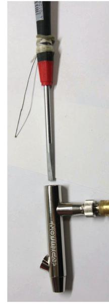
Diese sitzt etwas versteckt im hinteren Teil; siehe das kleine Messingteil in der Mitte. Die Dichtung bzw. deren Halterung muß mit einem Schraubendreher entfernt werden; idealerweise einer mit 4mm Klingenbreite.
