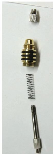
Dann sollte man ein sehr wenig (!!!) Öl auf die Achse des im Bild linken Teils und auf die Feder aufbringen; ich mach das mit einem leicht in Öl getränktem Wattestäbchen. Als Ölnehm ich entweder das feine Öl von Kontakt-Chemie oder zur Not auch mal das Allroundzeug WD-40.
