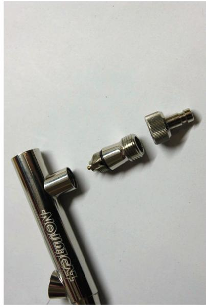
Wenn nein, ist das Ventil das Problem. Wenn ja, dann muss irgendwas im Luftkanal hängen oder es kann keine Luft um die Düse strömen. Für die Fehlersuche kann man die Düsenkappe abschrauben und mal trocken testen, ob da Lust ankommt. So kann man das Problem Schritt für Schritt eingrenzen.
