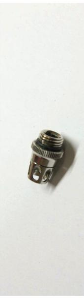
Das ist eigentlich diejenige, die am meisten Obacht erfordert. Durch das häufige Lösen scheint die mit am schnellsten zu verschleissen, und genau diese Dichtung ist auch vornehmlich für das oft geschilderte Blubbern im Farbnapf verantwortlich. Bei einem Defekt ist keine saubere Trennung von Luft- und Farbfluss Gegeben, so dass dann eben Luft in den Farbnapf gelangt und dort fröhlich blubbert...
