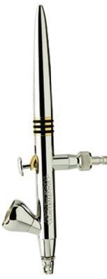
Mit Steckdüsen ausgestattet, ist die Evolution Two in One gerade für Airbrush Einsteiger sehr praktisch, da die Düsen selbstzentrierend sind und eine Beschädigung weitgehend ausgeschlossen werden kann. Die eingebauten Teflondichtungen sind unempfindlich für die Nutzung von Farben auf Alkohol und Lösemittelbasis. Mit ihrem Gewicht von ca. 95 g ist sie leider kein Leichtgewicht.
