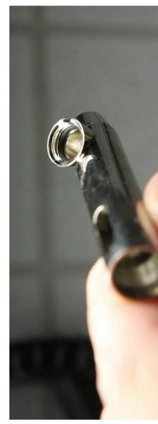
Hier sitzt unten am Gewinde, wo der Farbtrichter reingehört, ein dünner, schwarzer Gummidichtring.
